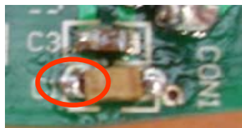
Figura N° 15. Falla por soldadura fría.
