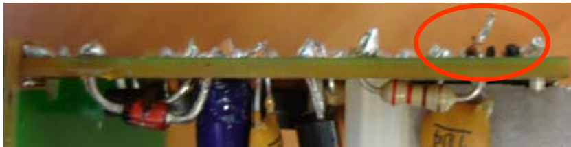
Figura N° 10. Falla de pista levantada vista lateral.
