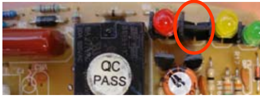
Figura N° 12. Falla por componente faltante en el PCB.
