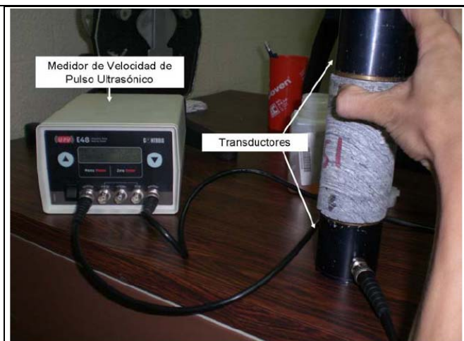
Figura 22. Equipos usados en el ensayo para la obtención de la velocidad de Onda P en roca. Medidor de pulso ultrasónico UPV-E48. Fuente: ALVAREZ,(2007)
