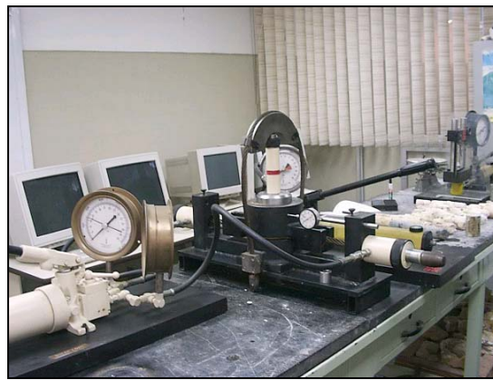
Figura 25. Equipo de Corte Directo, SBEL, RM-102. Antiguo laboratorio de Mecánica de Rocas, U.C.V.
