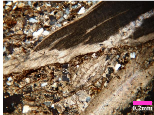
Fig. 4.12. Muestra 74A-89. Caliza Aloquímica Lodosa. Nícoles (X), Objetivo 4X.
