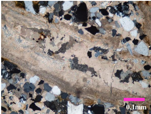
Fig.4.20. Muestra 337-89. Inversión Heteroaxial
