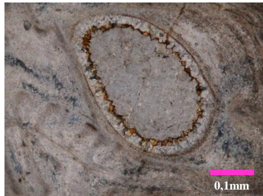
Fig.4.33. Muestra 96-89. Bordes dolomitizando
