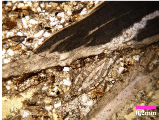
Fig. 4.11. Muestra 74A-89. Caliza Aloquímica Lodosa. Nícoles (//), Objetivo 4X.
