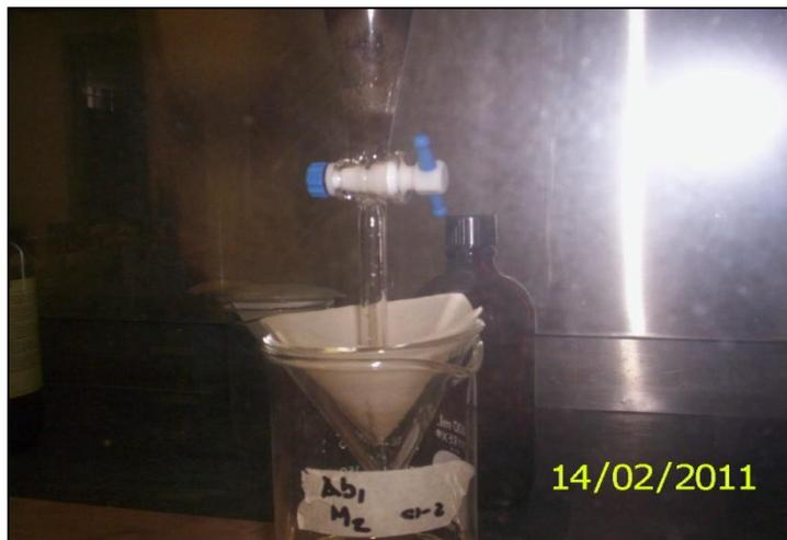
Figura 7. Proceso de recuperación de minerales pesados.
