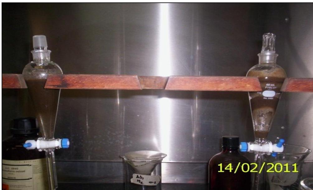
Figura 5. Mezcla de bromuro de acetileno y la muestra de sedimentos.
