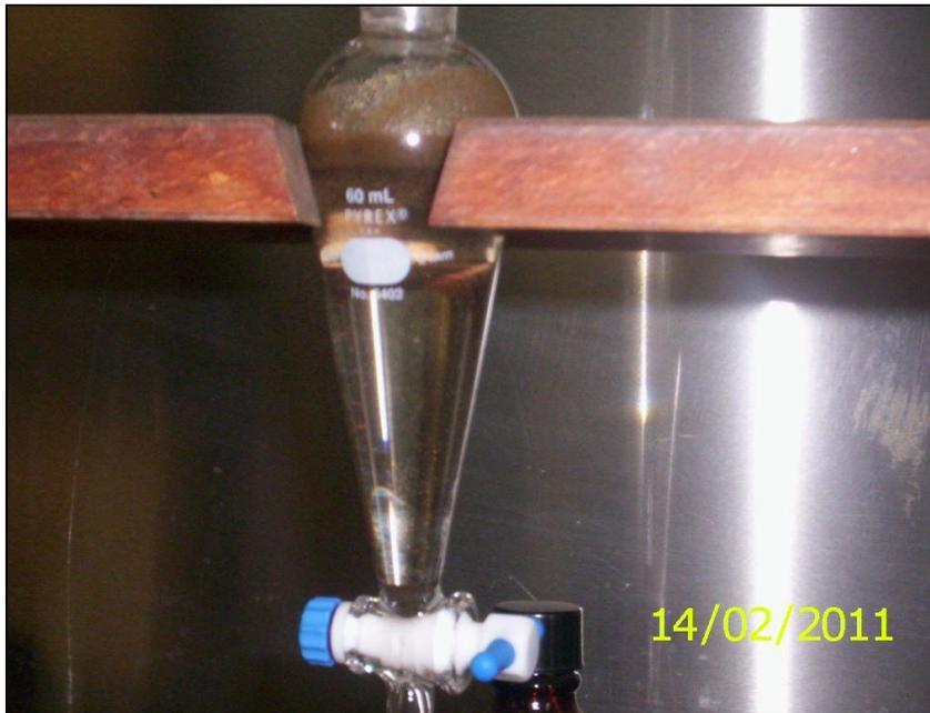
Figura 6. Embudo de separación al cabo de 40 minutos, se puede observar los minerales pesados ya precipitados.
