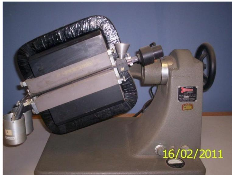
Figura 9. Separador isodinámico Frantz modelo L-1.
