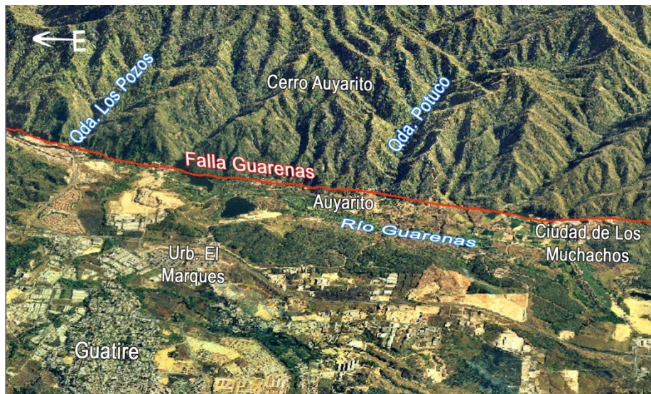
Figura 5.28. Modelo de elevación digital con vista angular del tramo comprendido entre la Ciudad de Los Muchachos y Los Pozos. Se señala en rojo la traza de la Falla Guarenas. Rumbo de la vista: S15^{\circ}W .
