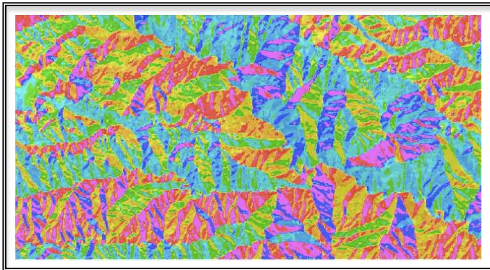
4.3.4.1 Modelo de Orientación de Laderas, elaboración del modelo de orientación utilizando la herramienta Aspect Analyst del ArcGis 9.2 a partir del MED.
