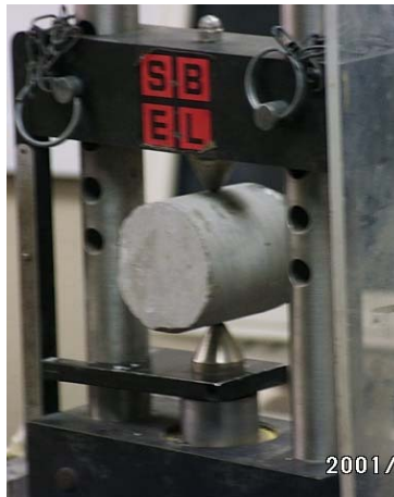
Foto 7.2. Ubicación de la muestra en equipo para ensayo de Carga Puntual Diametral
