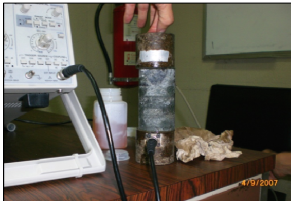
Foto 7.8. Ensayo de determinación de constantes elásticas por pulsos sónicos.
