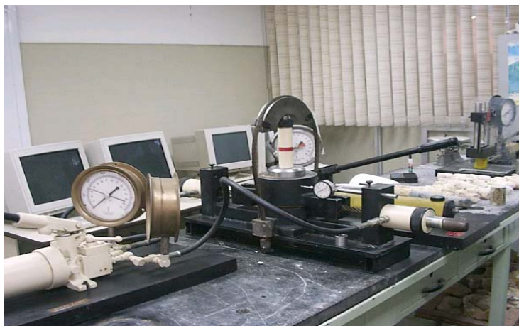
Foto. 7.7. Equipo de Corte Directo, SBEL, RM-102. Laboratorio de Mecánica de Rocas, U.C.V.
