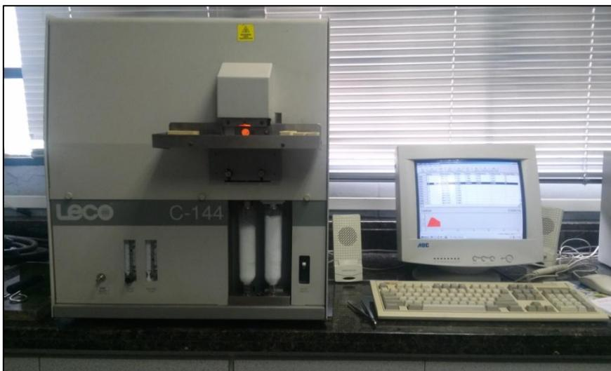
**Apéndice 3.** Analizador elemental Leco C-144 usado en la determinación de CT.
