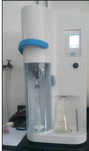
**Apéndice 5.** Unidad de destilación automática de Kjeldahl, marca Velp Scientific, modelo UDK149
