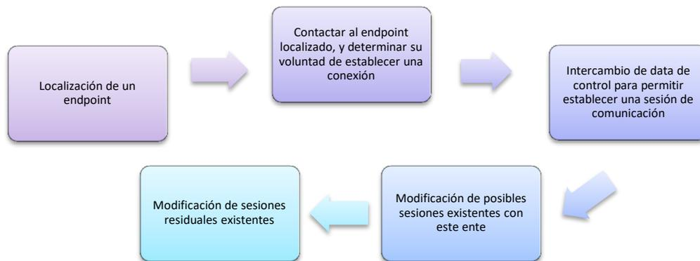
**Figura 3.1:** Flujo de Funcionamiento del Protocolo SIP
