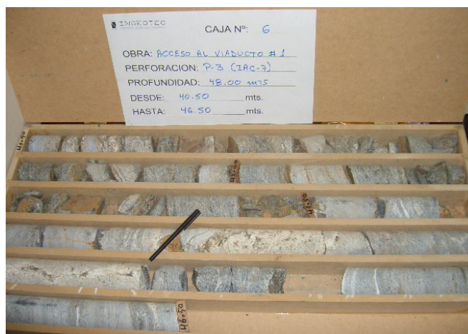
Imagen 4.2.- Muestras de una perforación realizada en el estribo sur del viaducto No 1, rotadas con un diámetro NX (500 mm) desde 40,5 hasta 46,5 metros de profundidad. Se observa la intercalación decalizas con esquistos, y algunos horizontes de anfibolitas granatíferas.
