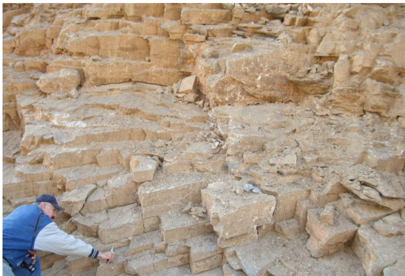
Figura 4.29.- Afloramiento de las calizas de la unidad II, en un corte realizado para el paso de la vía de contingencia (Rumbo de foto S12°E)
