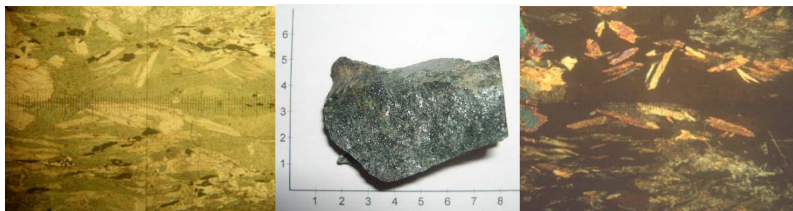
Figura 4.4.- Esquisto anfibolítico cuarzo micáceo grafitoso algo alterado encontrado en afloramiento bajo el estribo Norte del Viaducto No 1. Obj. 4X
