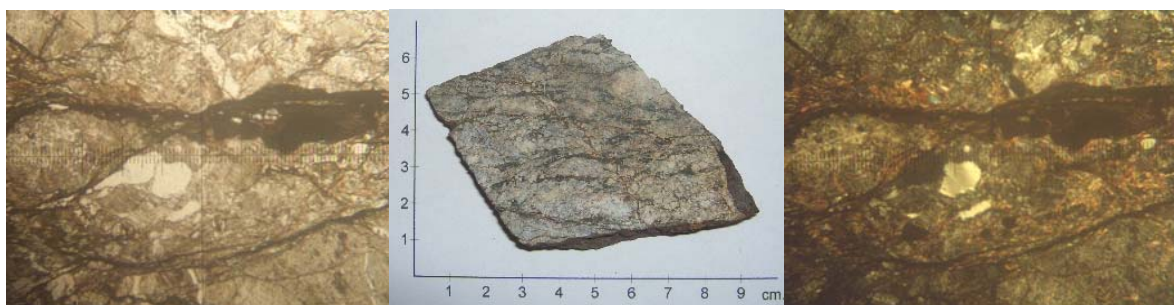
Figura 4.3. -Gneiss cuarzo micáceo anfibolico, muy alterado, oxidado Estribo norte Viaducto No. 1, 32m de profundidad .Obj. 4X
