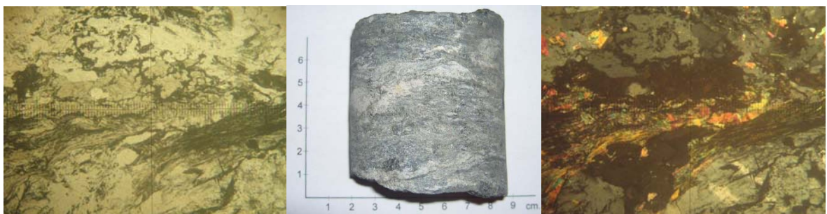
Foto 4.13 .-Esquisto cuarzo muscovítico grafitoso, alterado, presencia de microfallas Perforación cerca del estribo sur del Viaducto No 1 a 47 m de profundidad . Obj. 4X
