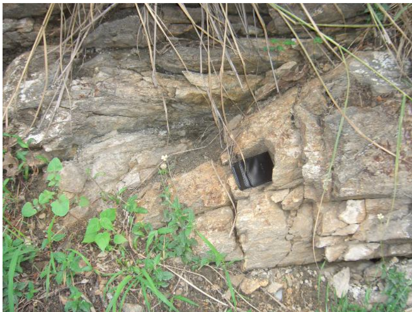
Figura 4.16. -Afloramiento de esquistos cuarzo micáceos gráfíticos observados en la progresiva 0+500 (Rumbo de foto S52°W)
