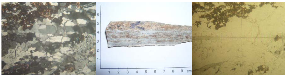
Figura 4.15.- Gneiss cuarzo micáceo, muy alterado con porosidad rellena por el óxido Afloramiento cerca del portal de la galería exploratoria superior. Obj. 4X
