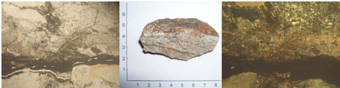
Figura 4.11 .- Esquisto calcáreo-cuarzo-feldespático-micáceo, muy alterado Perforación en el estribo Sur del Viaducto No. 1, a 25 m de profundidad. Obj. 4X
