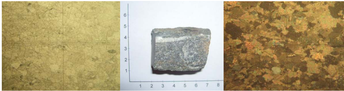
Foto 4.10 .- Mármol con minerales orientados de cuarzo, moscovita y grafito, bastante foliado. Afloramiento cercano al portal de la galería exploratoria superior. Obj. 4X
