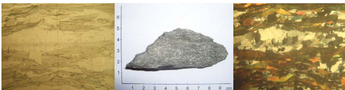
Figura 4.5.- Esquisto cuarzo muscovítico, con foliación muy bien desarrollada y blastos grandes afloramiento del meandro de la Quebrada Tacagua en la progresiva 2+600 de la autopista . Obj. 4X
