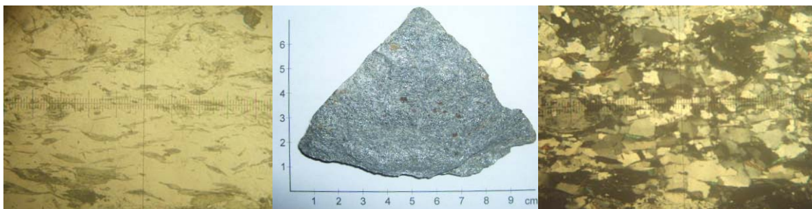
Figura 4.12 .- Esquisto cuarzo micáceo granatífero algo alterado 50 m al este del estribo sur del Viaducto No 1. Obj. 4X
