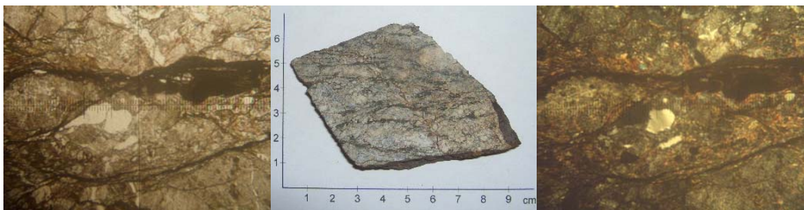
Figura 4.20.- Gneiss cuarzo micáceo anfibólico, muy alterado, oxidado estribo sur Viaducto No. 1, 32m de profundidad,. Obj. 4X
