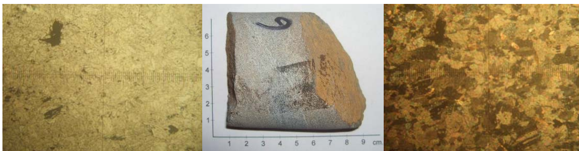
Foto 4.14.- Mármol con presencia de cuarzo, grafito y moscovita muy alterado en planos de debilidad Perforación cerca del estribo Sur del viaducto No. 1 a 33 m de profundidad . Obj. 4X
