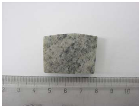
Figura 85. Fotografía de G04-28. Leuco-granito biotítico horbléndico con textura hipidiomórfica equigranular.
