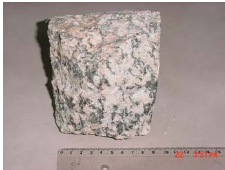
Figura 87. Fotografía de G04-56. Granito milonítico con textura hipidiomórfica inequigranular.
