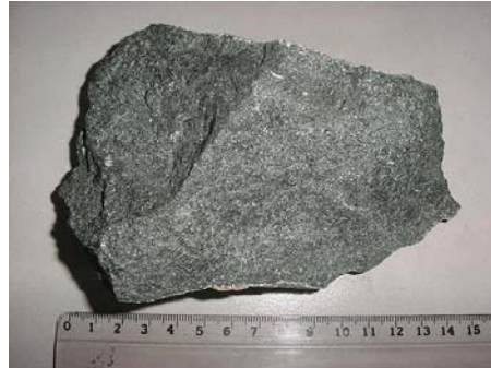
Figura 62. Fotografía de GR05-06. Meta-diabasa hornbléndica con textura fanerítica equigranular y tamaño de grano medio a fino.
