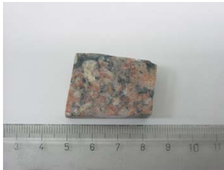
Figura 83. Fotografía de G04-15. Granito proto-milonítico con textura hipidiomórfica inequigranular.
