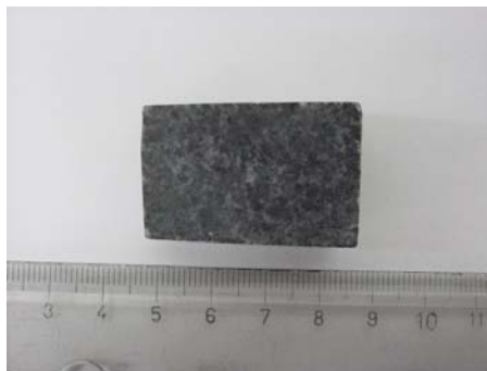
Figura 74. Fotografía de G04-20. Diabasa de composición gabroica con textura fanerítica equigranular.
