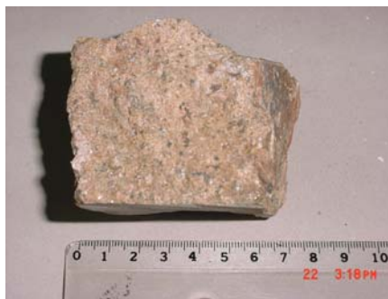
Figura 91. Fotografía de G04-64. Granito proto-milonítico con textura hipidiomórfica equigranular.
