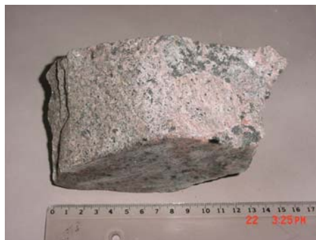
Figura 94. Fotografía de G04-69. Granito biotítico anfibólico con textura rapakivi. Obsérvese el pórfido rosado de microclino de 8 cm en su diámetro mayor con sobrecrecimiento de un anillo oligoclásico.
