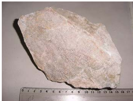
Figura 66. Fotografía de GR05-31. Granito con textura del tipo aplítica.
