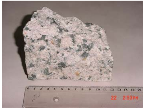
Figura 90. Fotografía de G04-63. Granito biotítico porfirico rapakivi con textura inequigranular hipidiomorfica.
