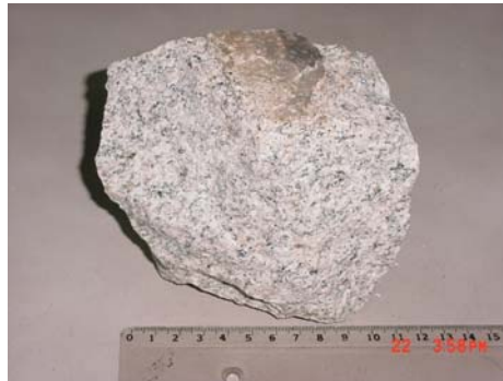
Figura 77. Fotografía de G04-01. Monzo-granito con textura equigranular hipidiomórfica.
