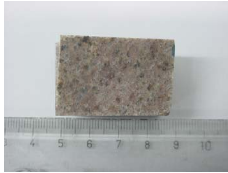
Figura 78. Fotografía de G04-05. Granito proto-milonítico del tipo tectonita con textura inequigranular porfírica.
