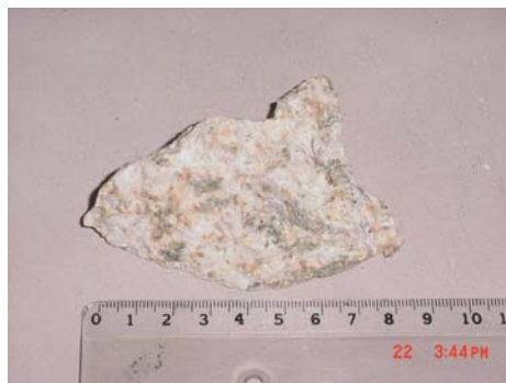
Figura 88. Fotografía de G04-57. Granito proto-milonítico con textura inequigranular hipidiomorfica.
