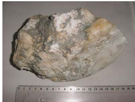
Figura 67. Fotografía de GR05-33. Roca con textura pegmatítica.
