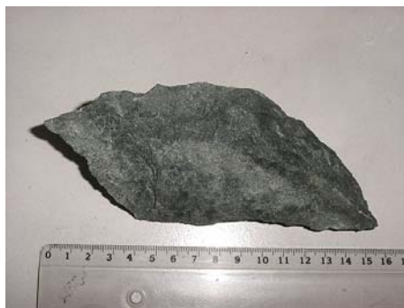
Figura 60. Fotografía de GR05-27. Meta-volcánica de composición diabásica con textura porfídica.
