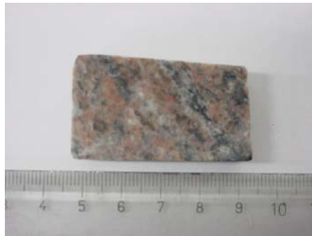
Figura 81. Fotografía de G04-09. Granito proto-milonítico del tipo tectonita con textura foliada.
