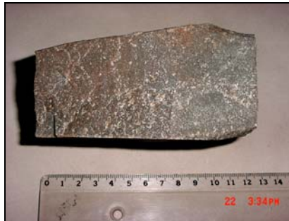
Figura 72. Fotografía de G04-61. Meta-dacita con textura inequigranular porfídica.
