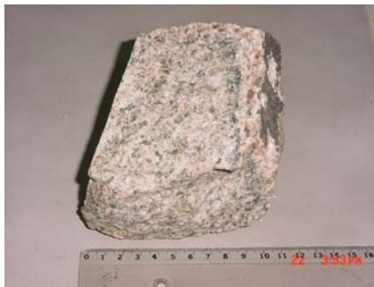
Figura 86. Fotografía de G04-55. Granito proto-milonítico con textura hipidiomorfa inequigranular.
