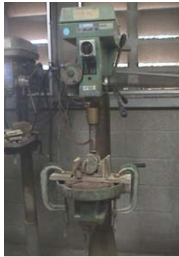
Figura 3. Taladro para la toma de tapones.
