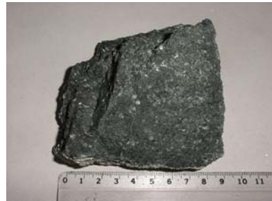
Figura 64. Fotografía de GR05-32. Meta-gabro horbléndico con textura fanerítica equigranular con tamaño de grano grueso.
