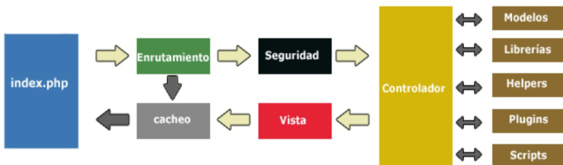
Figura 16. Flujo de una aplicación en CodeIgniter.
