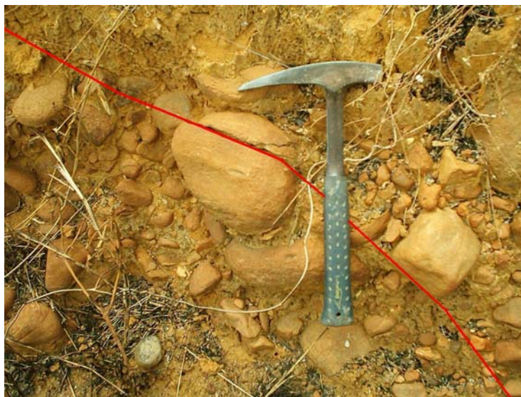
Figura 5.71. F2 de la Estación M20 resaltada en rojo. Nótese el desplazamiento dextral sufrido por el conglomerado a la izquierda de la piqueta.
