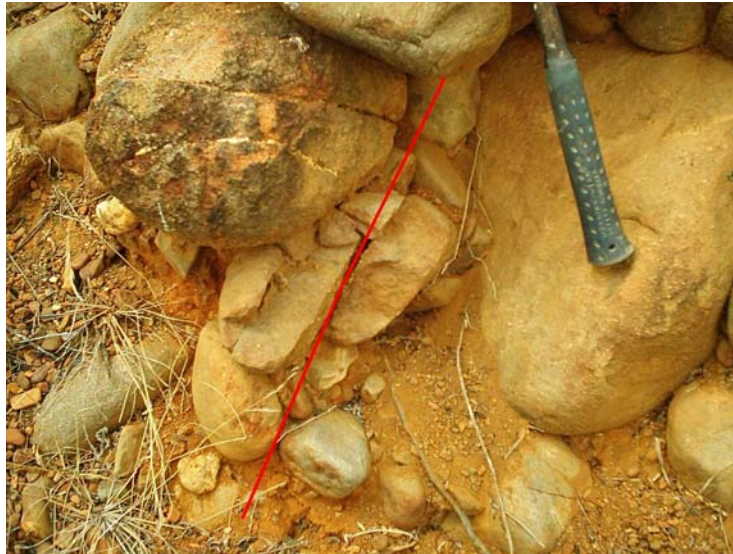
Figura 5.70. F1 de la Estación M20 resaltada en rojo. Nótese el desplazamiento sinistral sufrido por el clasto a la izquierda de la piqueta.
