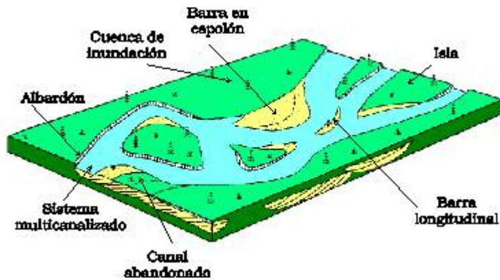
Figura 28.- Representación esquemática de los subambientes identificados en ríos anastomosados.
