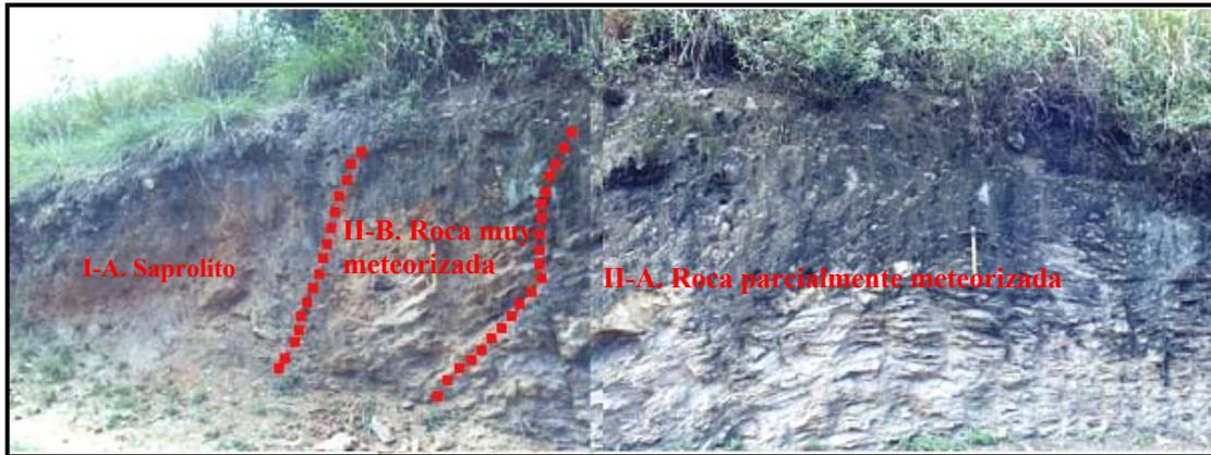
**Figura 40.** Detalle de talud en M7-ESTC 7, indicando horizontes de meteorización
