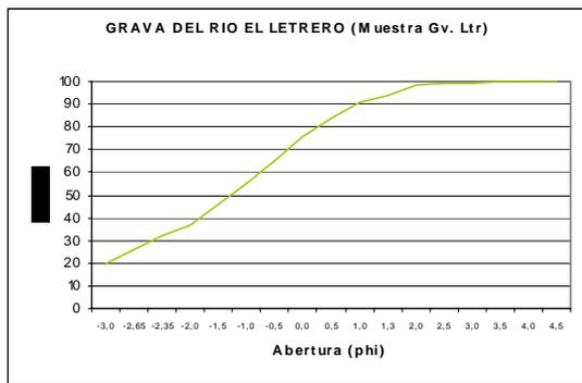
Las curvas de frecuencia acumulada para los sedimentos tamaño grava, presenta una pendiente abrupta en su parte inicial, esto se debe a limitaciones en el ensayo de tamizado, ya que no se contaba con tamices de mayor abertura, que permitieran una mejor gradación de la fracción gruesa.
