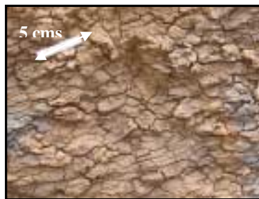
Fig. 4.9. Intervalo arcilítico donde se aprecia las coloraciones grisáceo-amarillentas, típicos de una meteorización de tipo químico.
