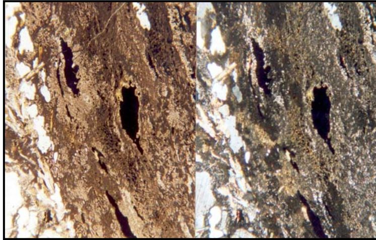
Fig. 62. Fotomicrografías de la sección RN-802-r 14 (N: // y X). Esquito sillimanítico plagioclásico micáceo. Sillimanita con textura afieltrada, biotita y plagioclasa. Minerales orientados.
