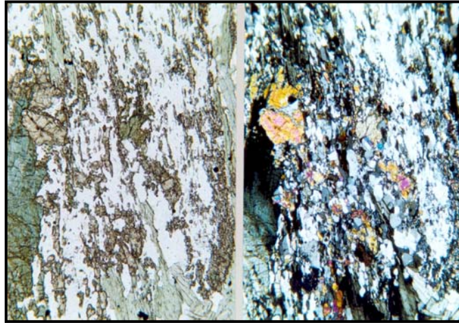
Fig. 151. Fotomicrografías de la sección QCh-802-r 5 (N: // y X). Gneis plagioclásico epidótico anfibólico. Porfidoblastos de epidoto y barrosita hacia la derecha. Minerales bien orientados. Cuarzo policristalino y con textura granoblástica.
