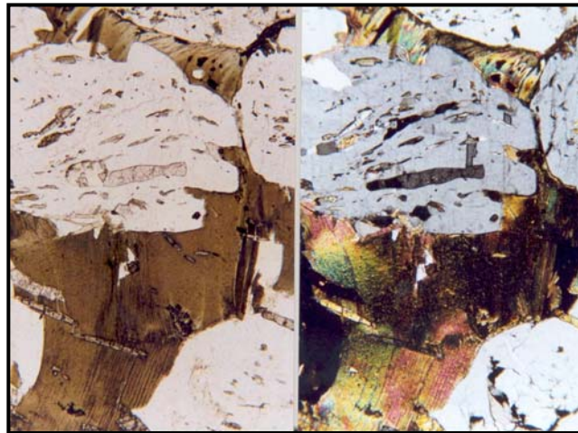
Fig. 82. Fotomicrografías de la sección RSJ-802-10 (N: // y X). Esquisto cuarzo-biotítico-epidótico-plagioclásico. Porfidoblastos de biotita y plagioclasa poiquiloblástica ovoidal.
