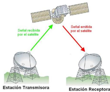
Figura 1: Sistema de transmisión y recepción satelital
