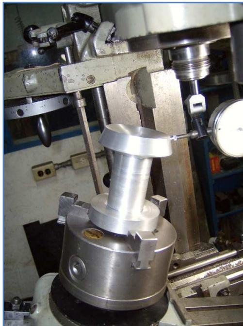
Figura A6: Fresado de la bocina cónica corrugada
