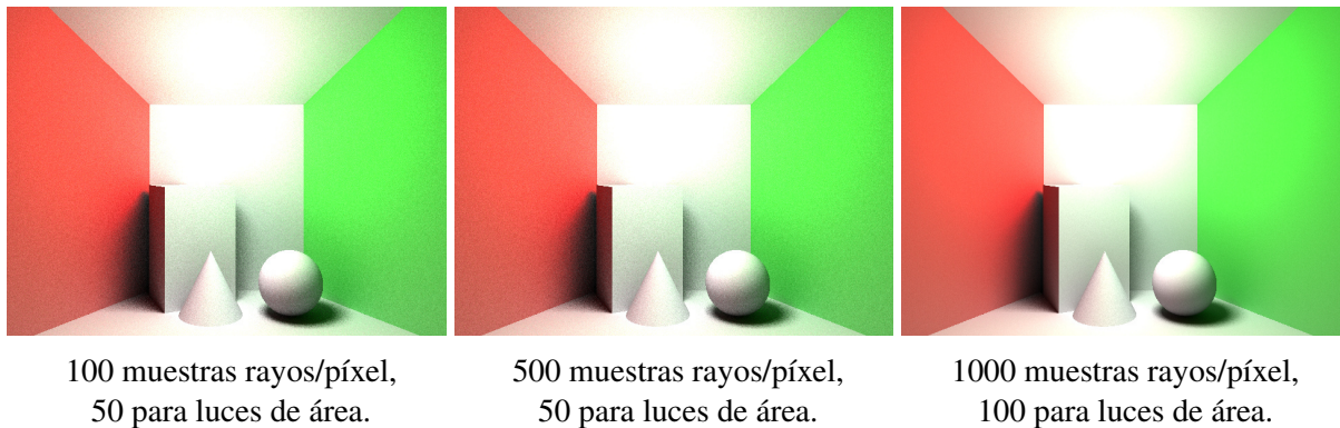
Figura 11: Ray tracing sobre una escena, se puede observar mayor calidad y reducción de ruido al aumentar la cantidad de muestras [12].
