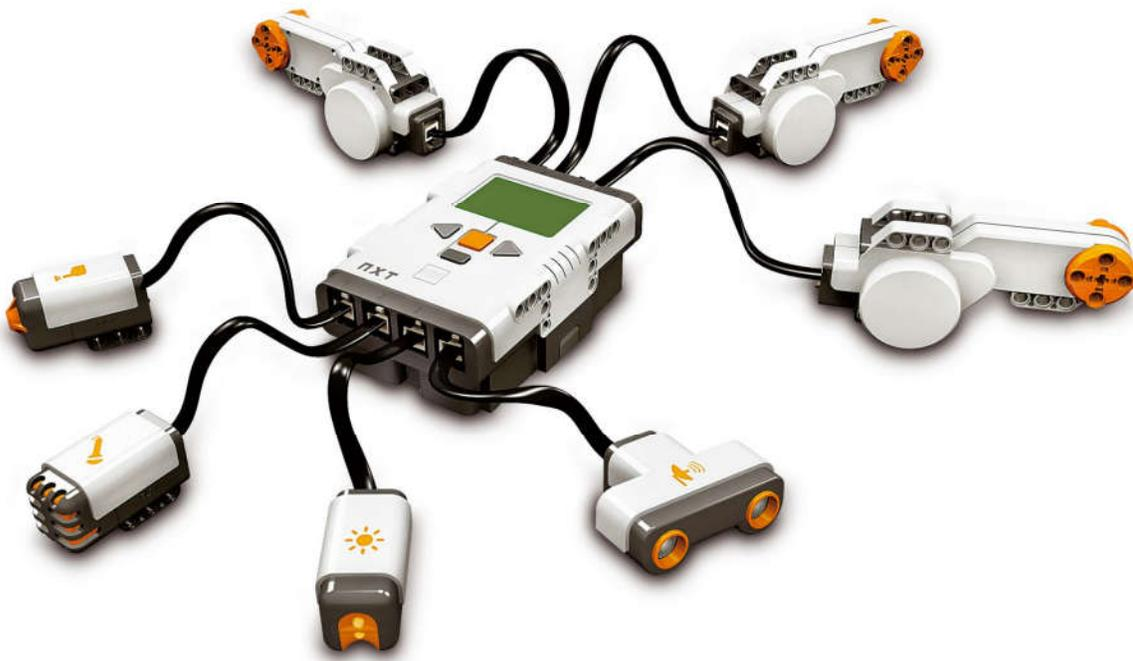
**Figura 2.2.** Bloque NXT con sensores y accesorios.
