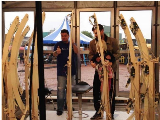
**Figura 3.11.** Pilares de escaneo de Pi 3D Scanner.
