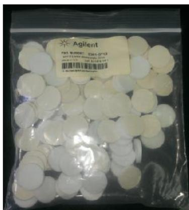
**Figura 9.-** Septum de silicón para viales de headspace
