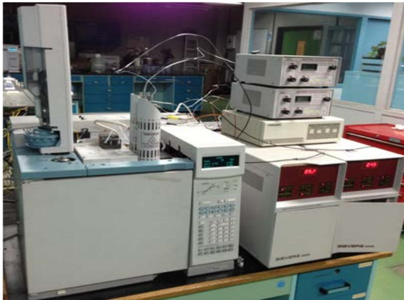
**Figura 24. Cromatógrafo de gases Agilent Technologies modelo 6890 acoplado a Detectores de quimioluminiscencia de azufre Sievers 335 y nitrógeno Sievers 255.**
