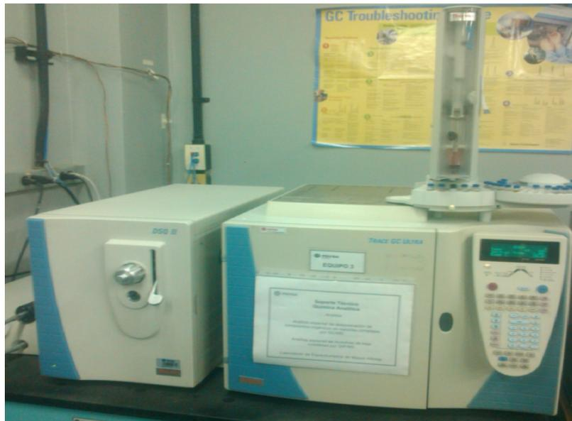
Figura 25. Cromatógrafo de gases marca Thermo Trace Ultra acoplado al espectrómetro de masas marca Thermo DSQ II.
