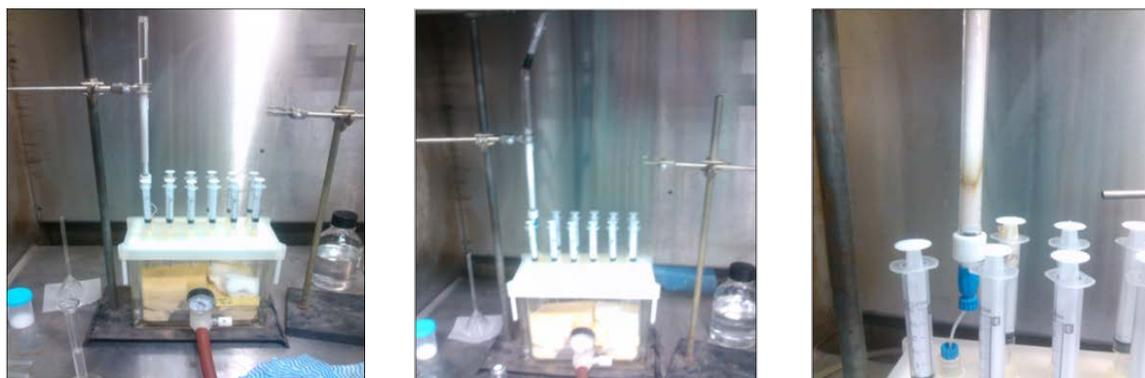
**Figura 26. Montaje y procedimiento de separación tipo SARA para muestra de VGO de referencia interna.**
