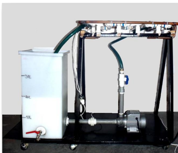
Fig. 15. Esquema del reactor solar empleado en la pruebas fotocatalíticas a escala banco
