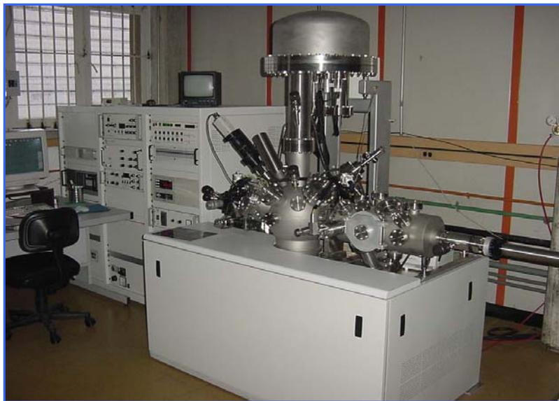
**FIGURA N° 22.** Equipo para el análisis de XPS
