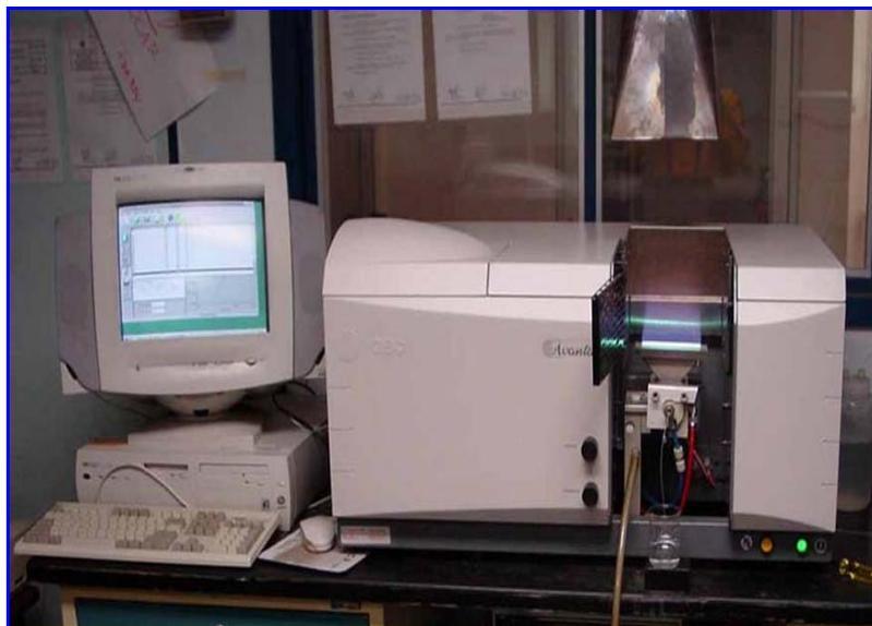
**FIGURA N° 18.** Espectrómetro de emisión atómica con plasma acoplado inductivamente
