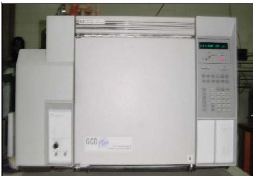
Figura 4.7 Cromatógrafo de gases con detector de masa HP G1820
