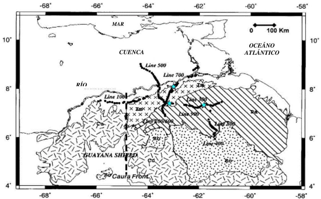
Figura 1.6 Mapa de localización de las líneas sísmicas del proyecto ECOGUAY. El frente de Caura divide la provincia de Imataca de la provincia de Cuchivero hacia el oeste. Las estrellas representan los puntos de disparo y los círculos los puntos de registros. Provincias geológicas del Escudo de Guayana después de Gibbs y Barron (1993). Im = Imataca, Pa = Pastora, Cu = Cuchivero, Ro = Roraima. Tomado de Schmitz et al. (2001).
