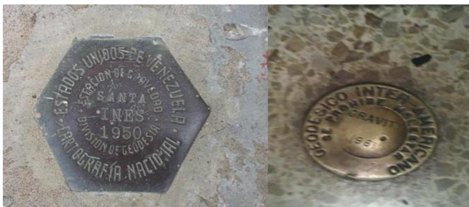
**Figura 4. 6** Bases gravimétricas con gravedad absoluta utilizadas para la calibración horizontal.
