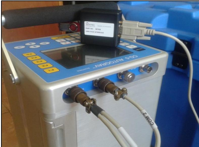
**Figura 4. 8** Conexión en el gravímetro para la descarga de datos.
