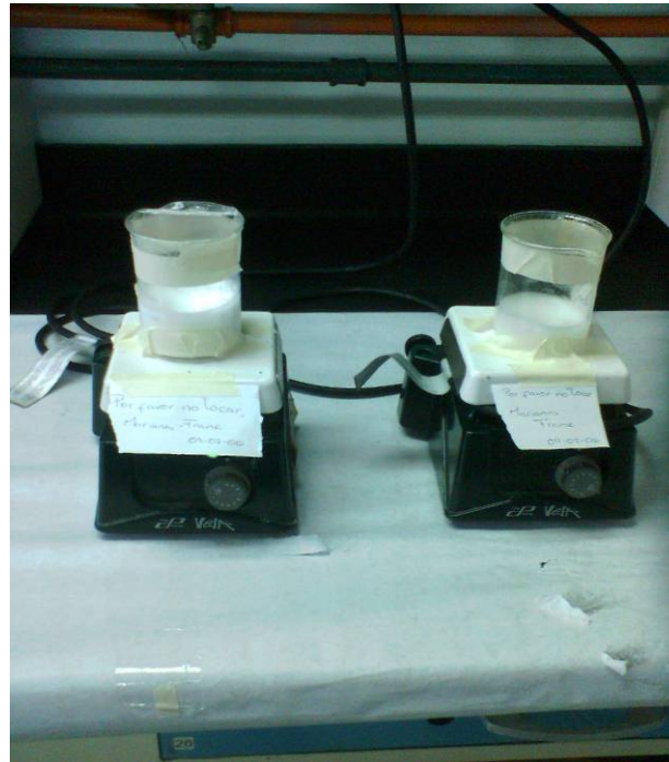
Figura 66. Lodos empleados para la impregnación de las esponjas poliméricas.
