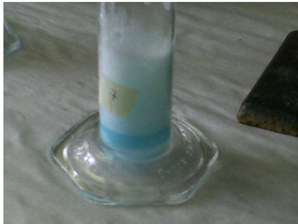
Figura 71. Titulación del sobrenadante por el método de azul de metileno, etapa inicial.
