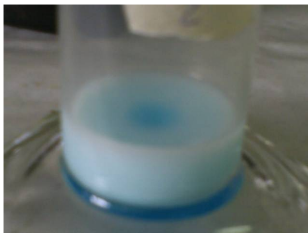
Figura 73. Titulación del sobrenadante por el método de azul de metileno, obtención del punto final.
