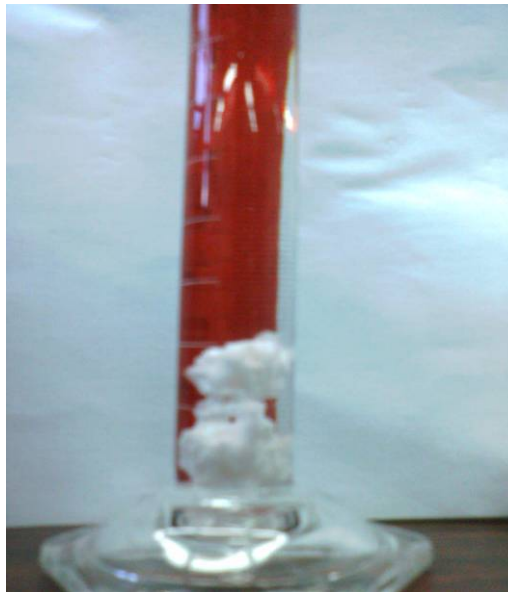
Figura 14. Medición del volumen vacío de las estructuras.
