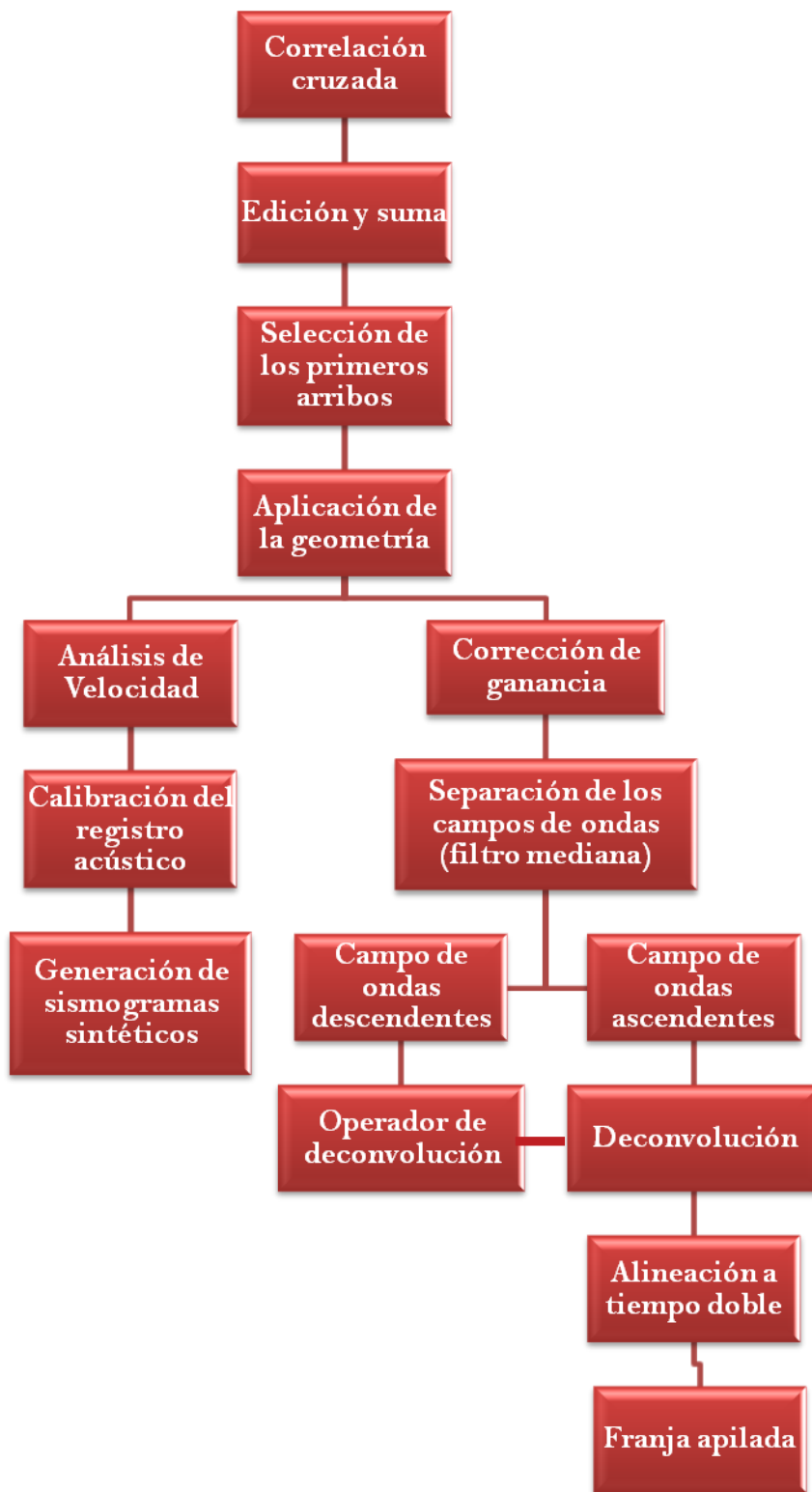
Figura 4.1. Secuencia de procesamiento del Cero Offset VSP.
