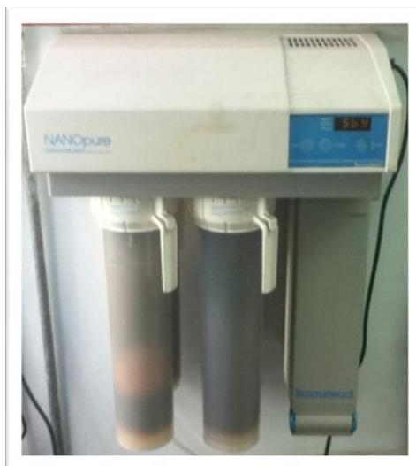
**Figura VIII.-** Desionizador de agua.
