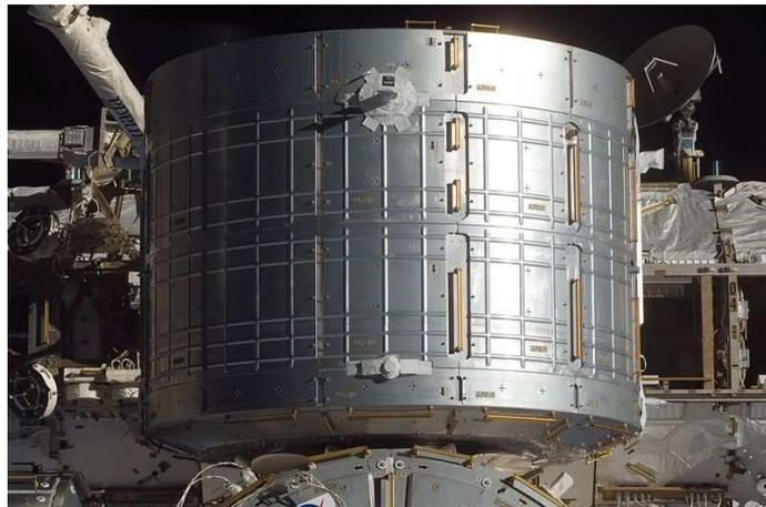
**Fig 1.6.- Componente ELM-PS del laboratorio Kibo**
