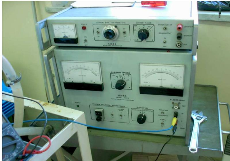
**Fig. 10.2: Alimentatore di corrente**
