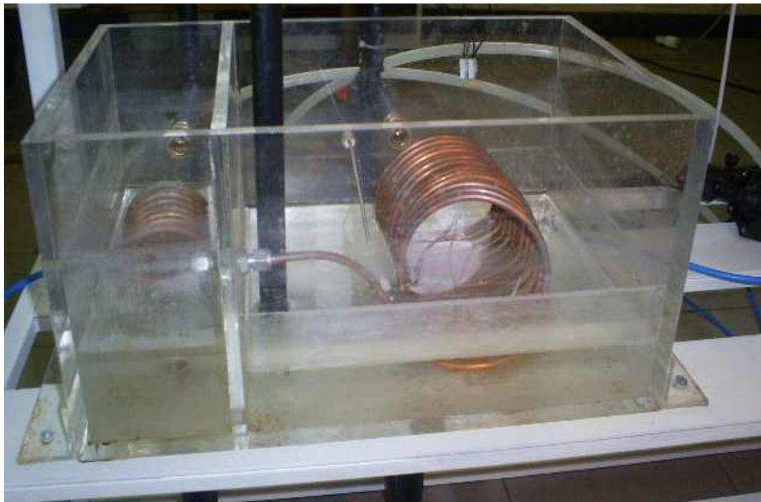
**Fig. 10.21: Serbatoio dell'acqua e della soluzione elettrolitica**
