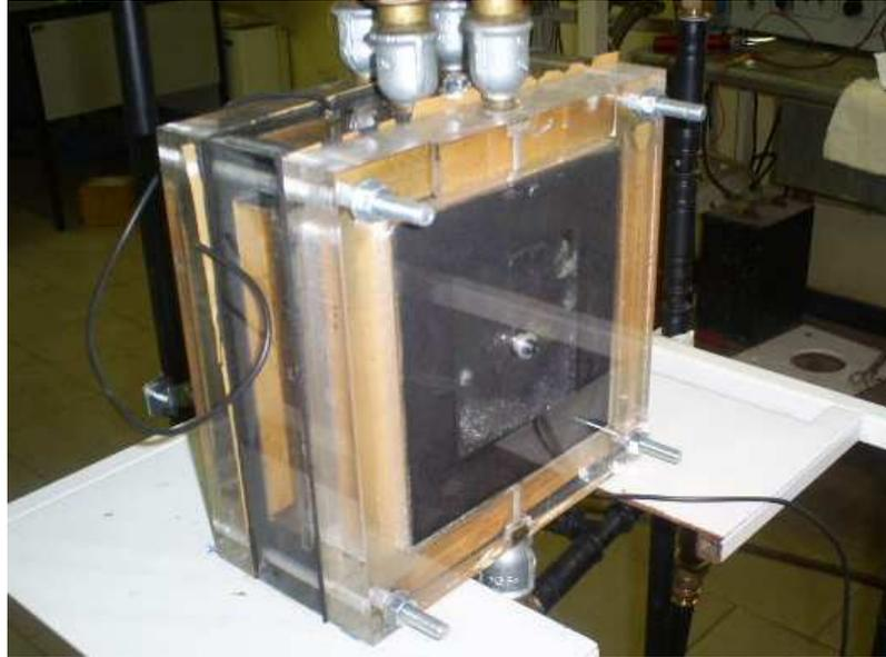
**Fig 10.13 – Cella elettrochimica assemblata**
