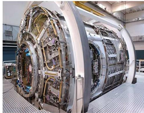
**Fig. 1.1: Nodo della Stazione Spaziale Internazionale in sala integrazione**
