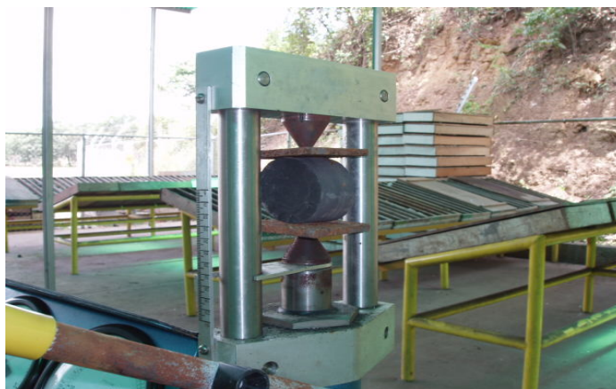
Figura N° 4.4. Colocación de la muestra para ensayo puntual (Propia)
