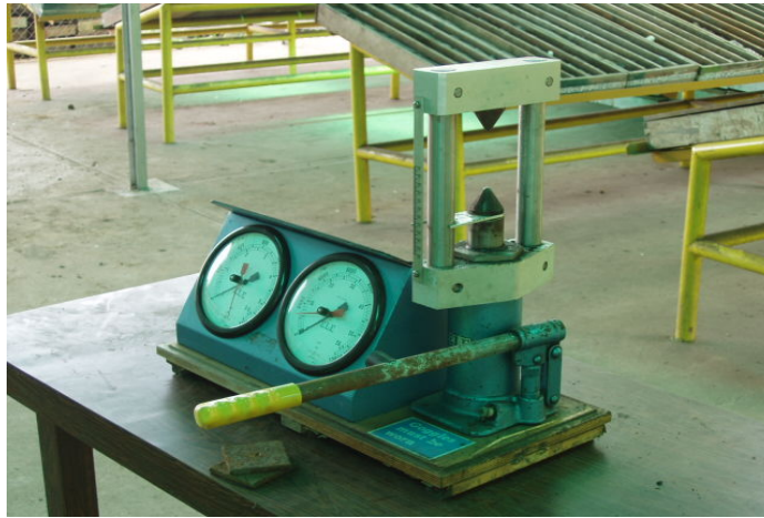
Figura N° 4.3. Prensa para ensayo puntual (Propia)
