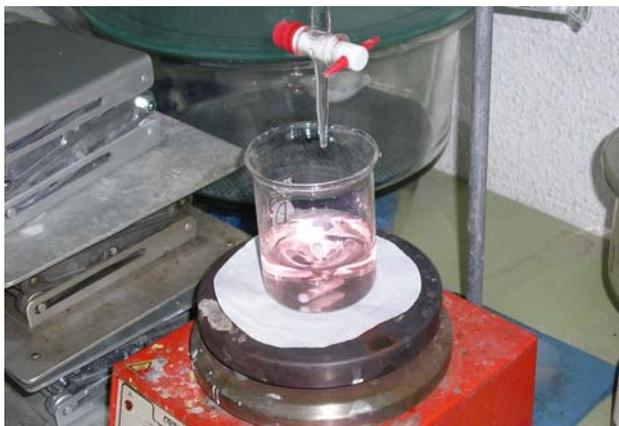
Figura 15: Tonalidad rosada clara luego de valorar con ácido clorhídrico
