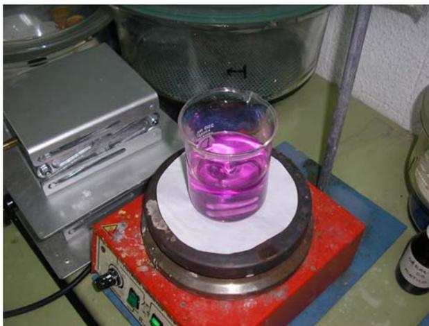
Figura 17: Tonalidad morada luego de valorar con la disolución de EDTA
