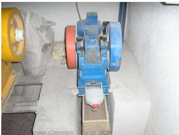
Figura 5: Machacadora de mandíbulas marca Controls
