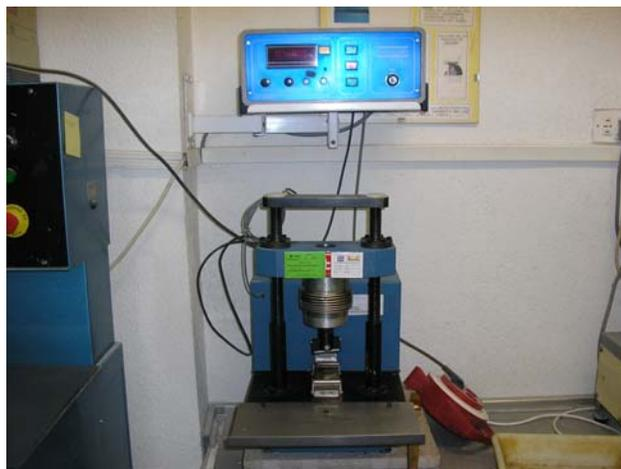
Figura 11: Flexímetro marca Ibertest
