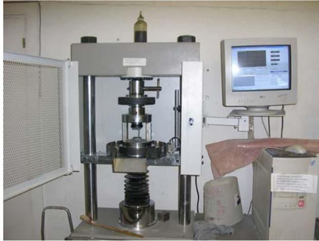
Figura 12: Máquina para realizar los ensayos a compresión
