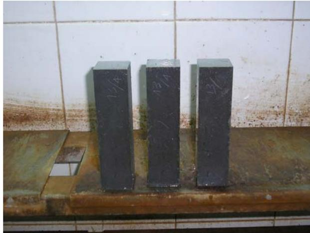
Figura 10: Probetas desmoldadas e identificadas
