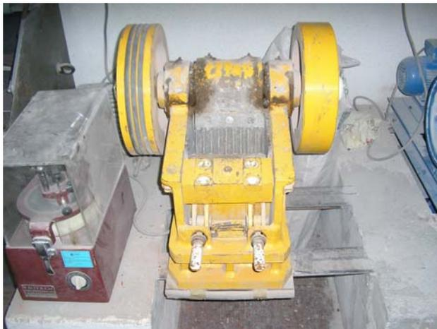
Figura 4: Machacadora de mandíbulas marca Alas
