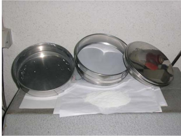
Figura 7: Aspecto de la granulometría del material luego de la molienda y el tamizado
