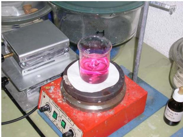
Figura 16: Tonalidad púrpura luego de agregar el indicador de murexida
