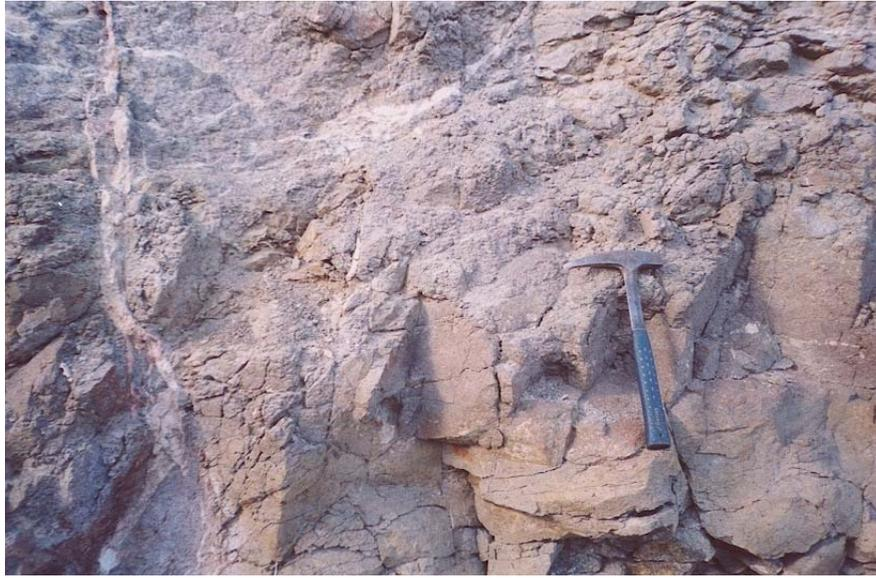
**Figura B-7: Brechas de andesita anfibólica**
