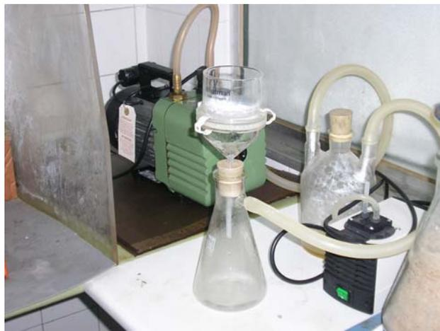
Figura 13: Equipo de vacío para el filtrado
