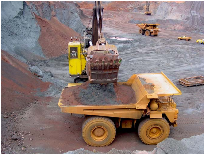
Ilustración 12 Operación de Carga. Mina Los Barrancos
