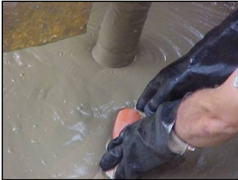
Fig.5.13 Obtención de las muestras del suelo tratado.
