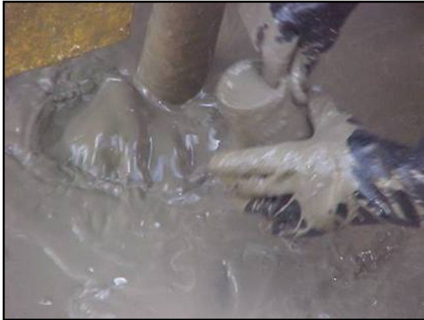
Fig.5.15 Obtención de las muestras del suelo tratado.
