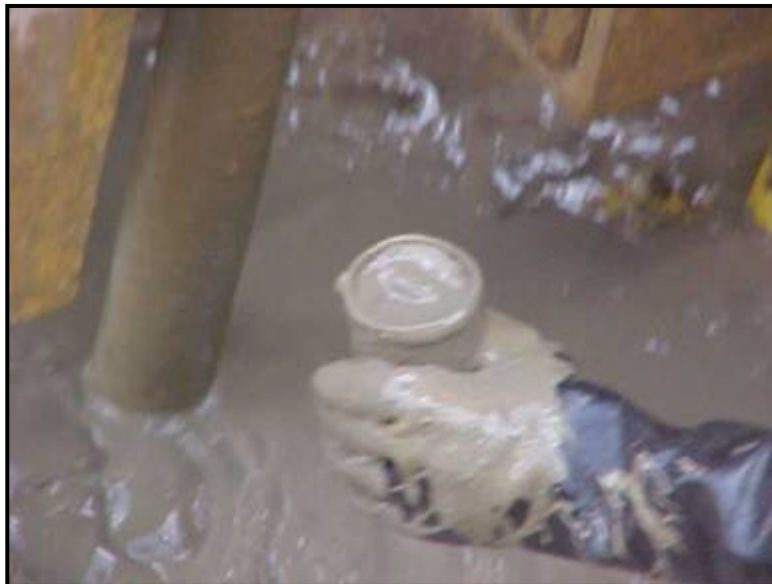
Fig.5.13 Obtención de las muestras del suelo tratado.
