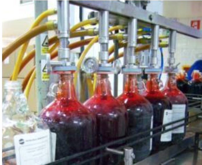
Fig. 21 Línea de Producción Líquidos Golden, PCV Planta de Concentrados: Envasado.
