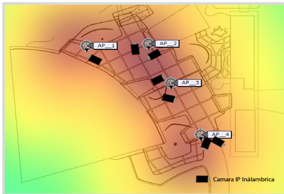
Figura 3.33: Señal captada por las cámaras en la Plaza Cubierta.
