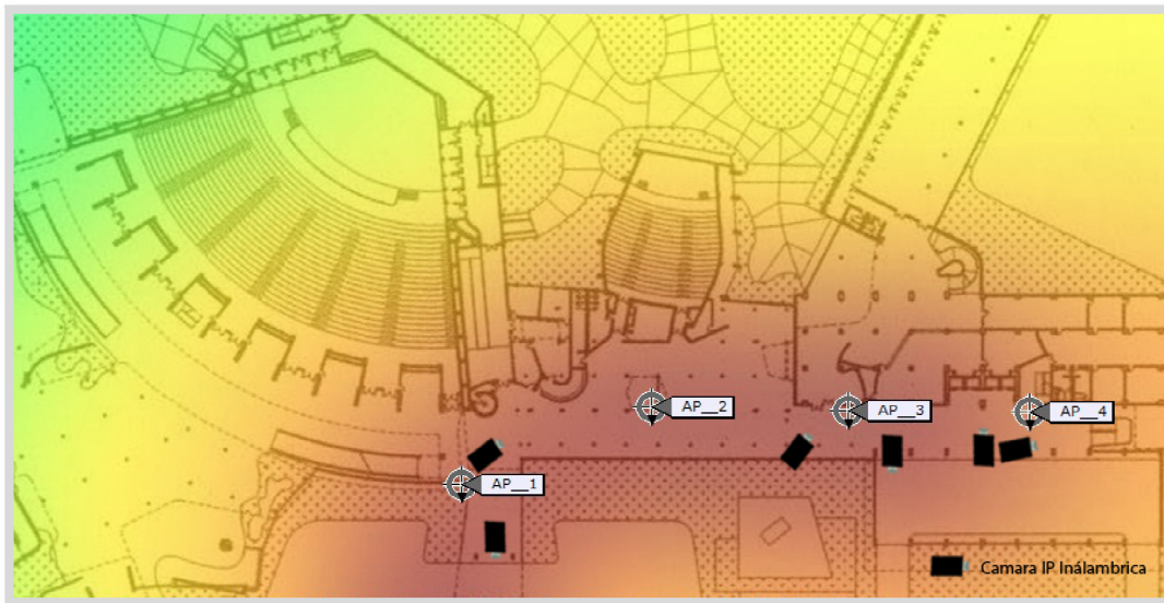
Figura 3.35: Señal captada por las cámaras en el Complejo Cultural Aula Magna.
