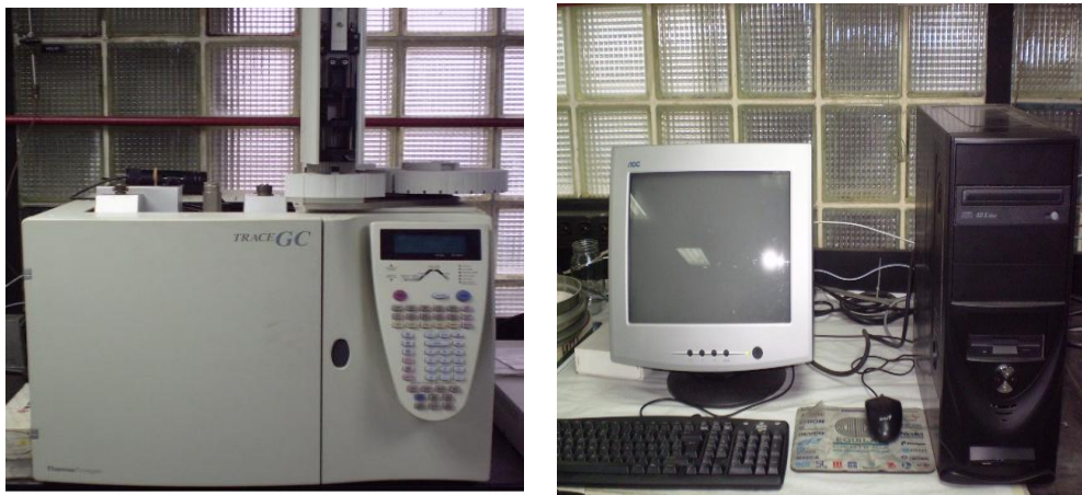
Figura N° 15. Equipo de cromatografía de gases y equipo computarizado con el sistema de adquisición de datos.
