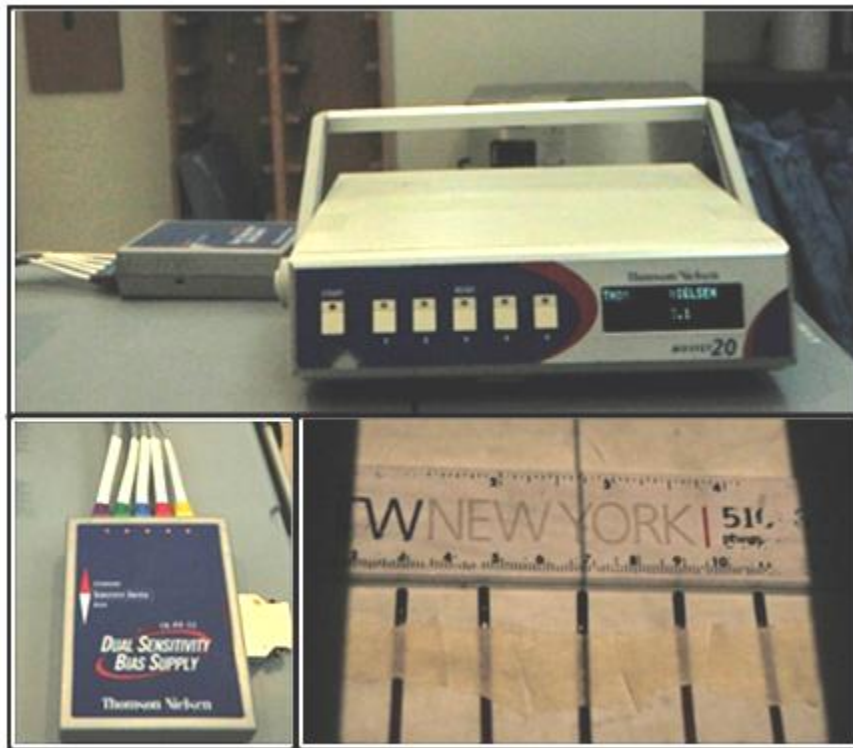
Figura 22: Detectores de estado sólido. Arriba: lector donde se visualizan los valores de voltaje medidos. Abajo: caja de voltaje de polarización de cinco canales donde se conectan los dosímetros al realizar la lectura (izquierda), y dosímetros (derecha).
