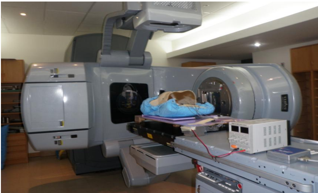
Figura 33: Tomografía realizada en sala de tratamiento con el sistema Cone Beam CT incorporado al acelerador.
