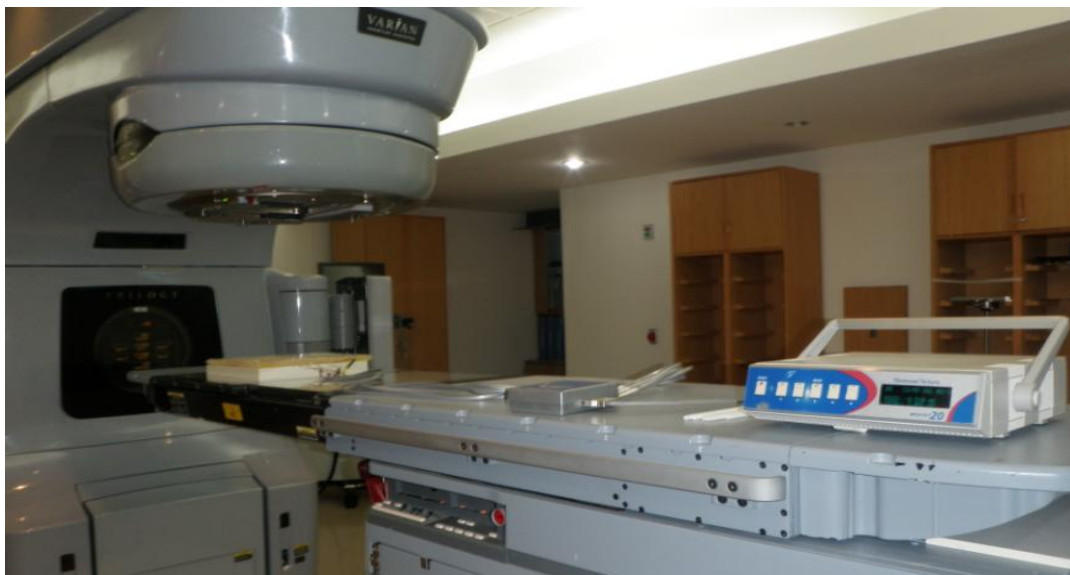
Figura 25: Montaje experimental para realizar la calibración de los mosfet.
