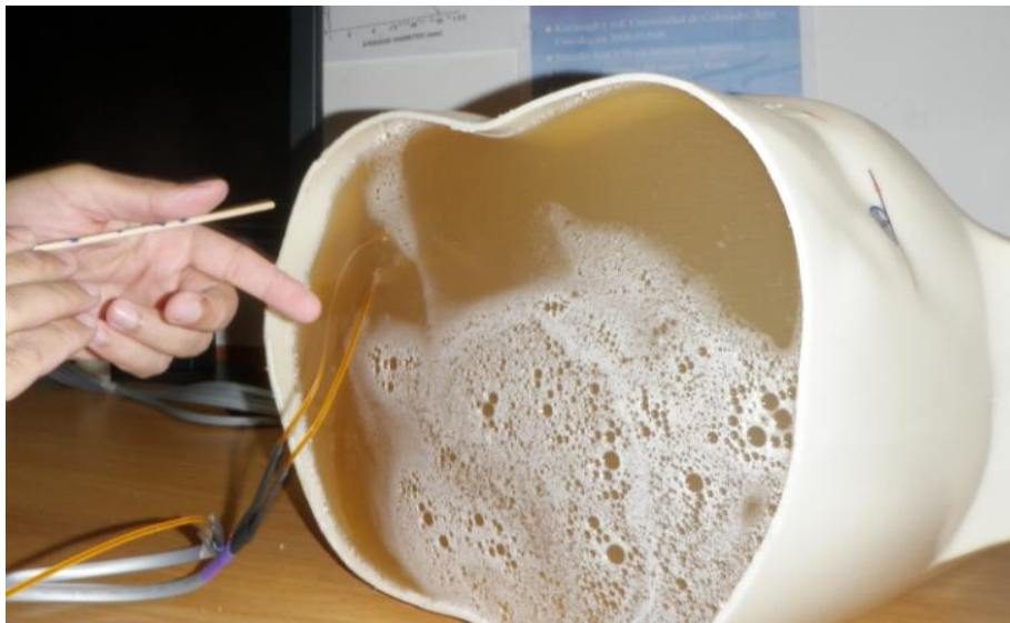
Figura 31: Colocación de mosfet en maniquí.
