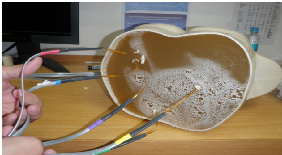
Figura 39: Dosímetros colocados dentro del maniquí.
