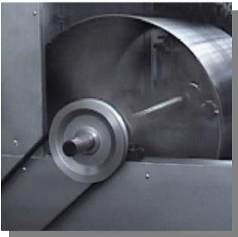
Fig. 6.1 Polea acoplada al eje
