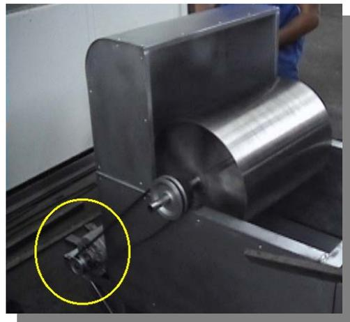
Fig. 6.2 Polea acoplada al motor
