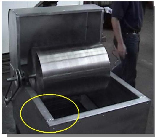
Fig. 5.3 Unión de ángulo de estructura
