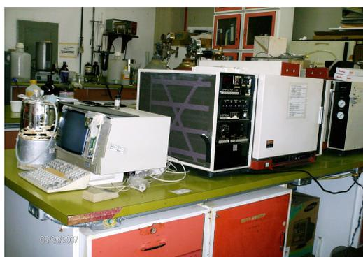
**Figura 68.** Equipo utilizado en el análisis de reacción de HDS. Cromatógrafo de gases VARÍAN modelo 3700.
