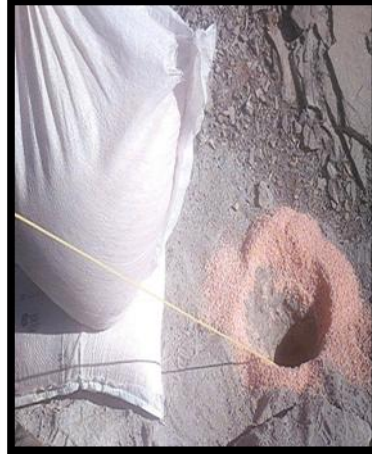
Figura 3.7: ANFO Utilizado en Minería a Cielo Abierto
