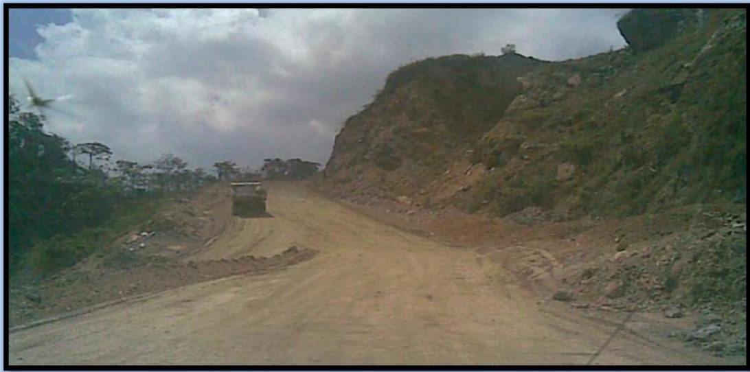
Figura 3.12: Rampa de Acceso Entre la Cantera y la Planta de Trituración. Subiendo Cargado y Bajando Vacío los Camiones.
