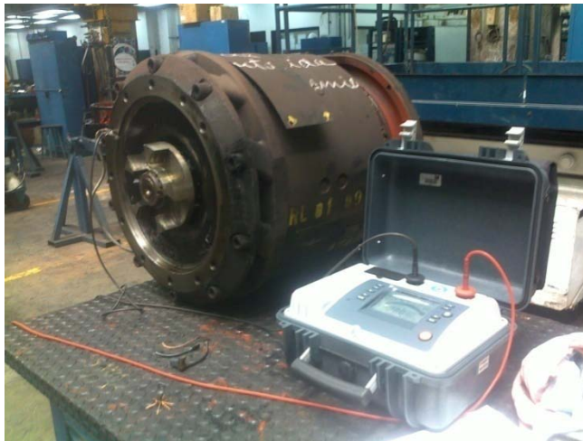
Fotografía 7: Medición del nivel de aislamiento en motor de tracción MT1-508. [Fuente: el autor]
