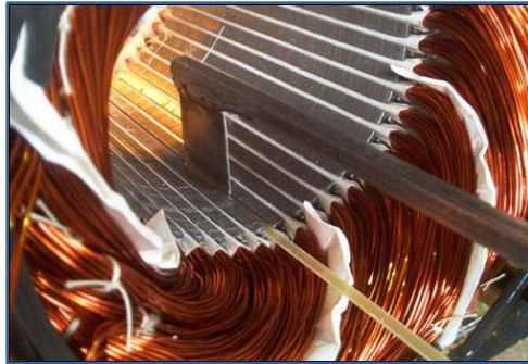
Figura 2.1: Arrollado aleatorio en el estator. [2]
