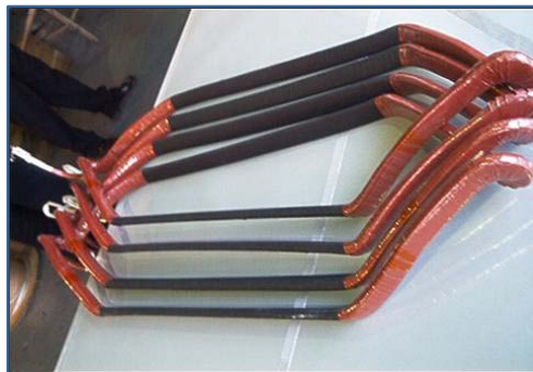
Figura 2.2: Arrollado rotórico preformado con núcleo multiconductor.[2]
