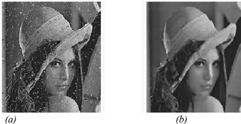
*Ilustración 5: Efecto de filtro mediana sobre imagen. (a)original con ruido sal y pimienta, (b)mediana.*
