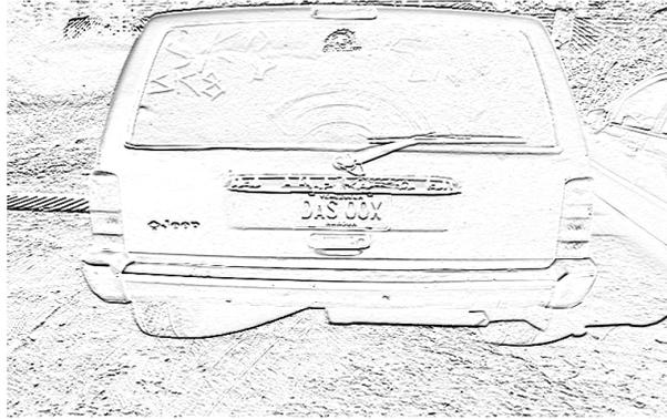
*Figura 25: Imagen de automóvil con filtro Sobel dirección horizontal*
