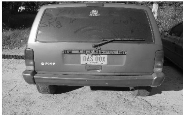
*Figura 20: Imagen convertida a escala de grises usando componente Y del espacio YIQ*
