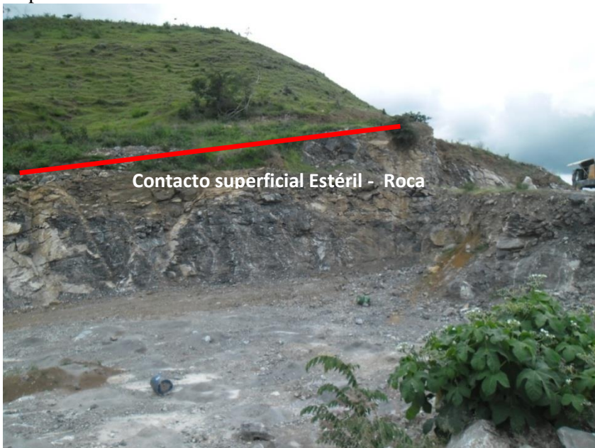
Figura 10 – Contacto de Caliza con Estéril para la cantera “El Samán”. Fotografías tomadas en Campo
