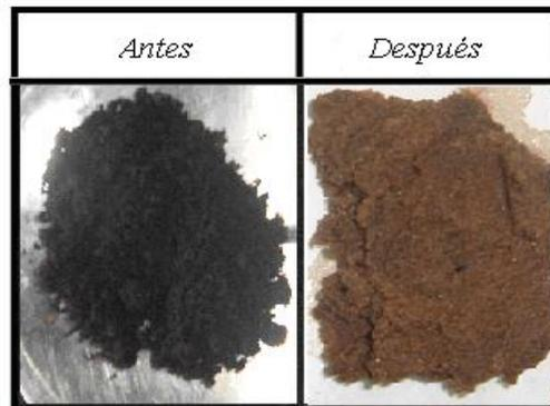
**Figura N° 24.** *Contenido de crudo antes y después del lavado con la solución acuosa de Sustancias Húmicas. (Fuente: propia)*
