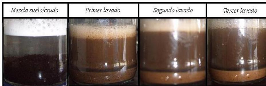
*Figura N° 22. Proceso de lavado de la muestra suelo/crudo con la solución acuosa de Dodecil Sulfato de Sodio. (Fuente: propia)*
