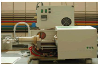
**Fig. N° 19 Equipo de Análisis Termo Gravimétrico (TGA). Utilizado.**
