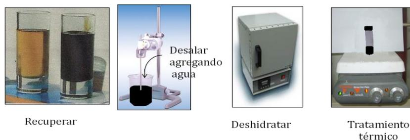
**Fig. N° 15 Recuperación, desalación, deshidratación y tratamiento térmico.**
