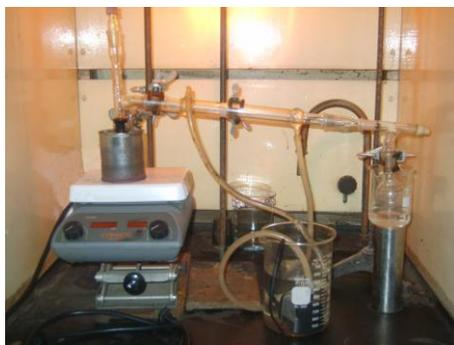
**Fig. N° 16 Sistema de microdestilación Quickfit ® utilizado.**
