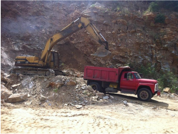
Imagen N°8: Combinación de carga y acarreo. Fuente; Propia 2016
