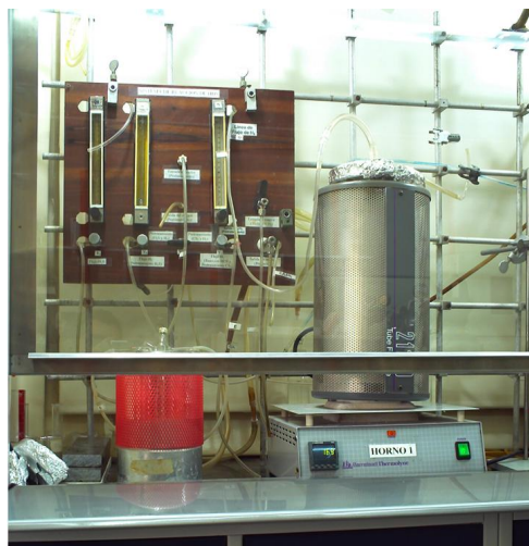
Figura N° 18: Imagen del equipo empleado en la hidrodesulfuración de tiofeno.
