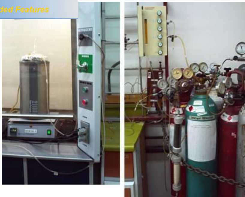
Figura N° 9: Equipo empleado en la síntesis de NbN x .
