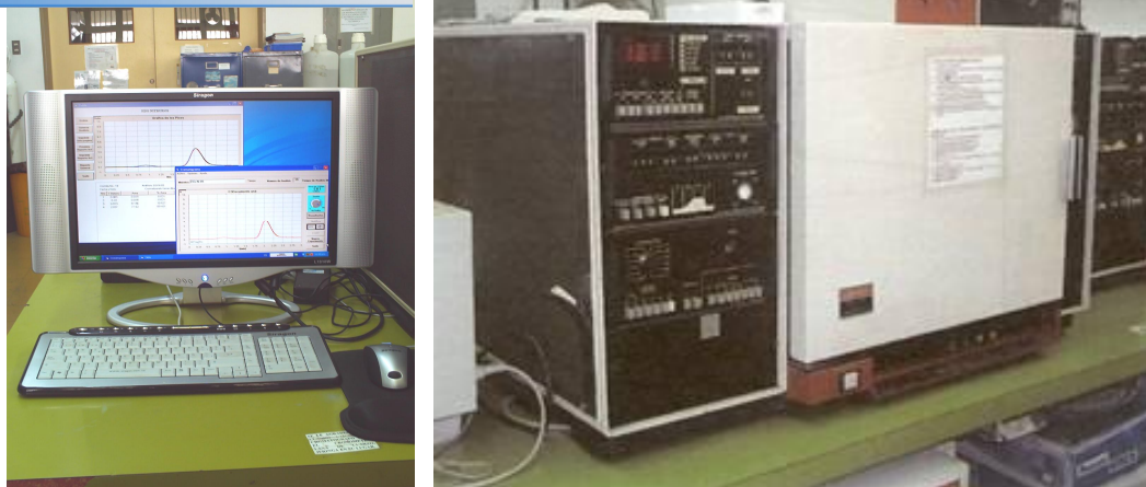
Figura Nº 14: Equipo de Cromatografía con Integrador acoplado.
