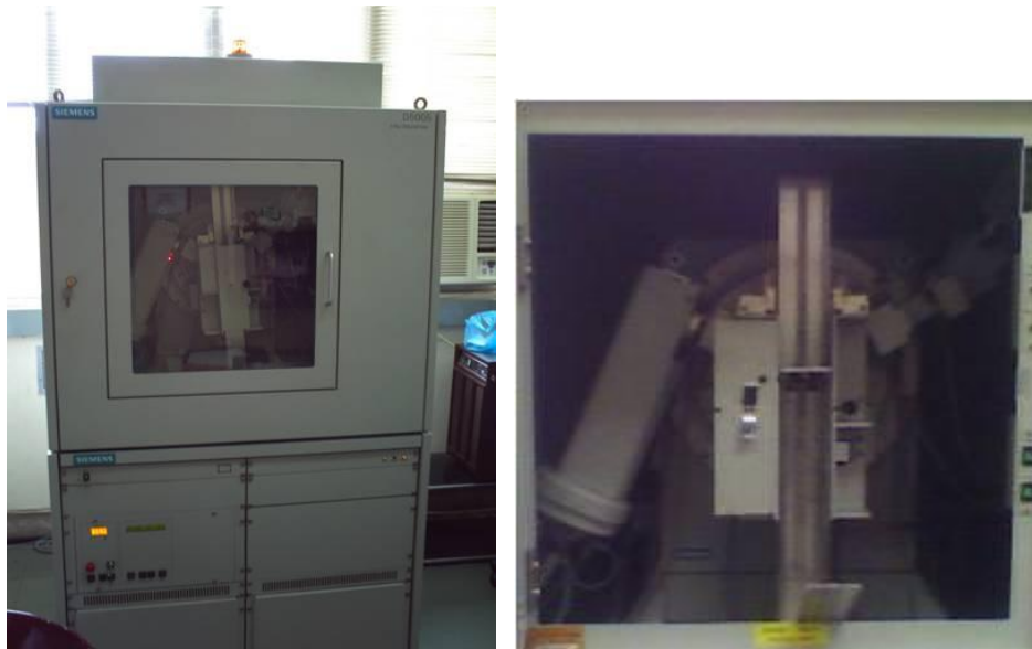
Figura N° 12: Equipo de Difracción de Rayos X, marca SIEMENS D5005.
